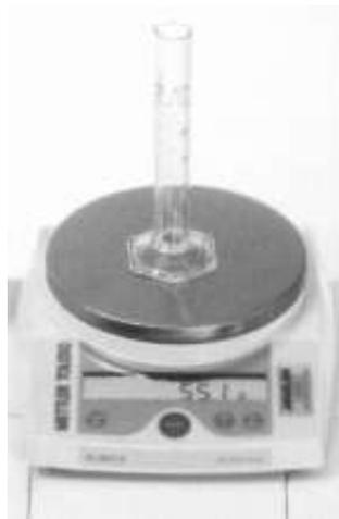
Peser une éprouvette graduée vide. Puis peser cette même éprouvette remplie de 20 mL d'éthanol :
