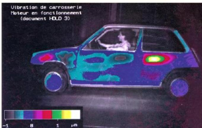
Doc. 2c Hologramme double exposition obtenu avec deux impulsions laser de 30 ns chacune séparées de 200  $\mu$ s.
