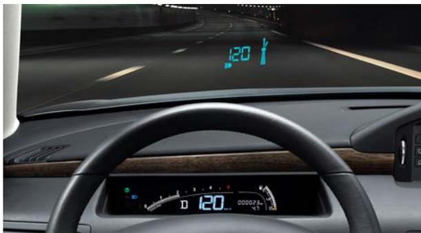
**Figure 8. Vue du tableau de bord d'un véhicule muni de l'affichage tête haute**
