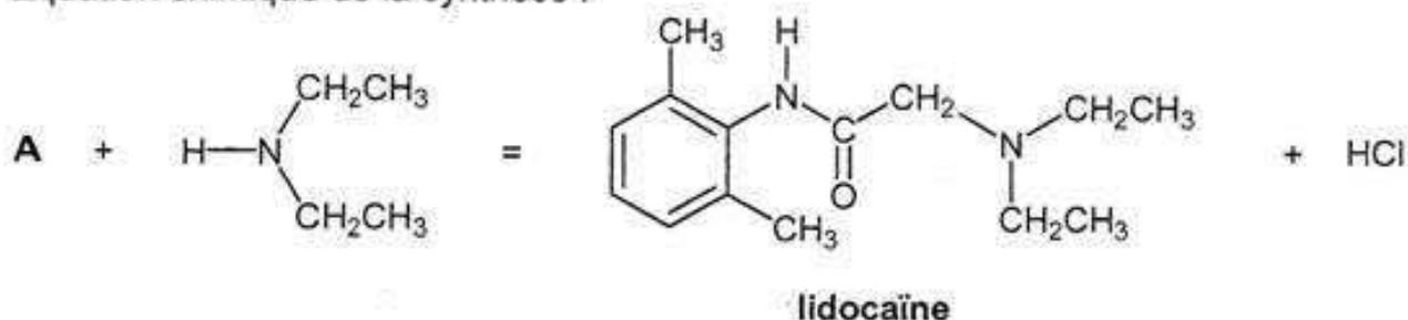
Pour suivre la formation de la lidocaïne, on réalise quatre prélèvements (1) (2) (3) (4) du mélange réactionnel aux différents instants de dates respectives :  $t_1 = 0$  min ;  $t_2 = 20$  min ;  $t_3 = 60$  min ;  $t_4 = 90$  min. Ces quatre prélèvements sont placés au fur et à mesure dans une enceinte à basse température. Ainsi, la composition de chacun des prélèvements en attente reste constante.
