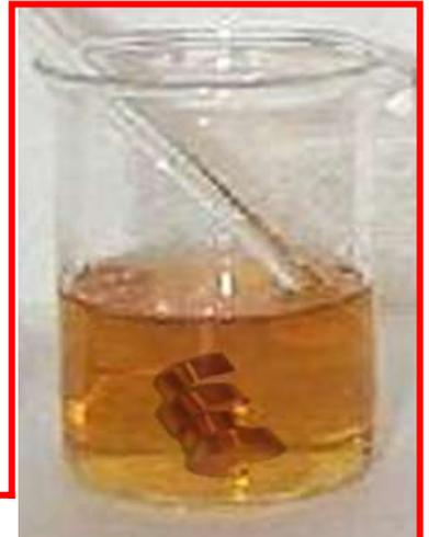
Dans un bécher, on mélange des copeaux de cuivre ( $\text{Cu}_{(s)}$ ) et une solution d'eau de dibrome ( $\text{Br}_{2(aq)}$ ) de concentration de  $0,01 \text{ mol.L}^{-1}$  (solution jaune).
