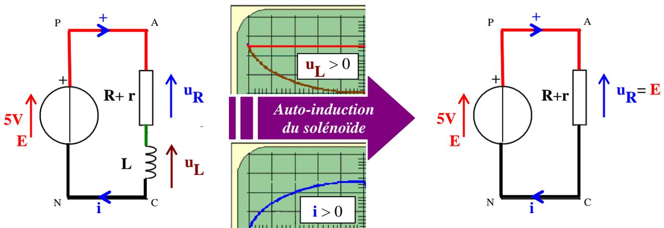
Le générateur bascule de **0 à 5 V** et tente d'établir le **courant  $i$**  positif. Cette brusque variation  $di$  auto induit un contre courant qui finit par s'éteindre lorsque  $i$  est enfin installée ( $i$  constant). Les évolutions temporelles du **courant  $i$** , de la tension  $u_R$  traduisent celle du solénoïde  $u_L$ .
