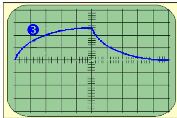
La **tension  $u_R$**  en ③, *image à R près du courant  $i$  circulant dans le circuit*, est continûment positive.
