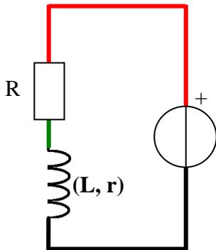
Comme lors du dipôle R, C on constate un retard à l'allumage de la lampe. L'évolution temporelle du dipôle R, L série doit présenter quelques similitudes avec le dipôle R, C série. La lampe est là encore remplacée par cette résistance R.
