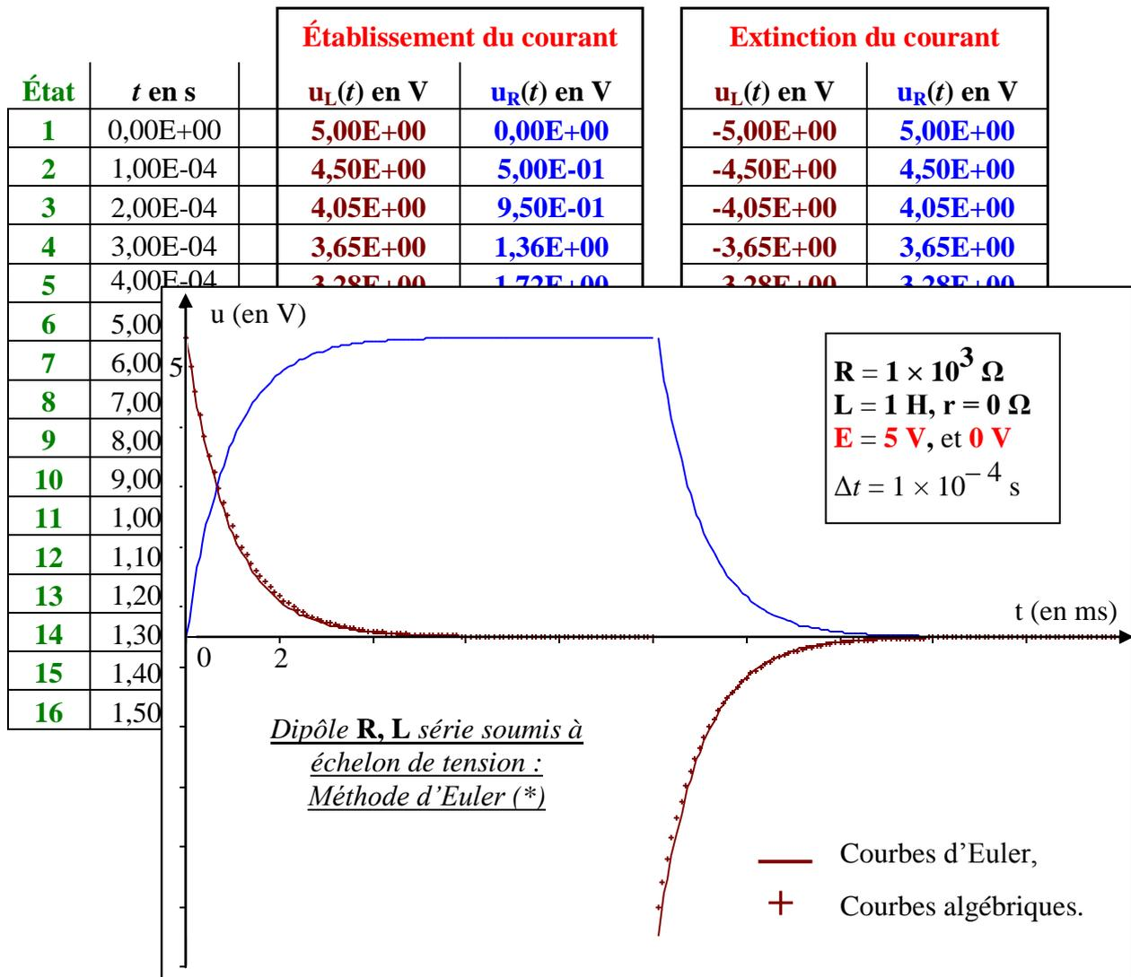
(\*) Les courbes de  $u_R = R i$  et de  $u_L$  sont volontairement représentées conformément au tableau de valeurs. Les colonnes  $\Delta i$  et  $\Delta u_L$  ne sont pas présentes pour plus de clarté, mais nécessaires aux calculs.
