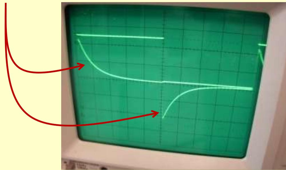
$u_R = u_{GBF} - u_L$  et donc visualisée à l'oscilloscope par la commutation **Voie I – Voie II**.
